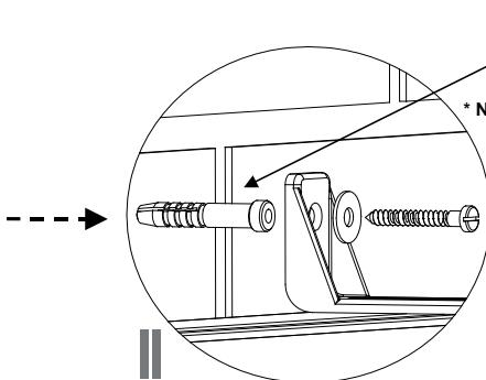
Utilizzare le viti "Vs" e le rondelle "Rs" in dotazione per fissare la squadretta "Sts" al tettuccio dell'armadio (fig I). Successivamente fissare la squadretta "Sts" alla parete (fig II). Per il fissaggio al muro utilizzare viti\* e tasselli\* adeguati alla tipologia di parete a disposizione \* NOT INCLUDED
