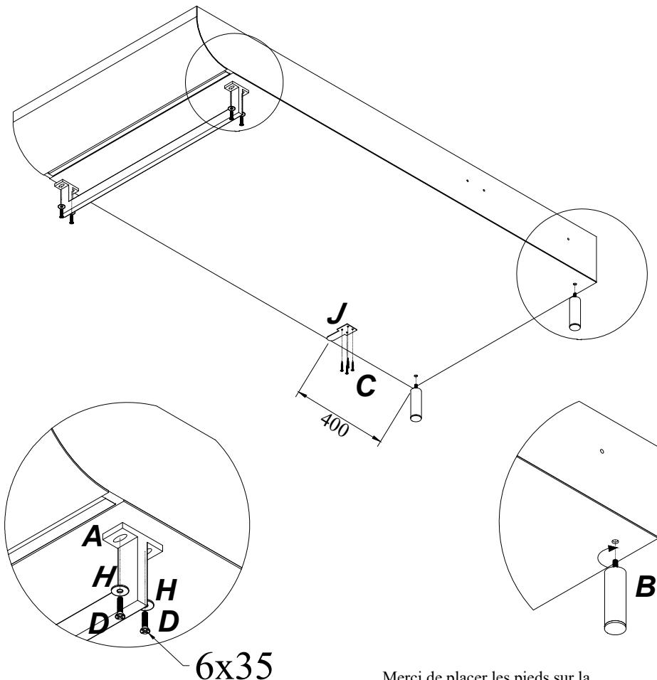
Merci de placer les pieds sur la structure, à l'endroit indiqué par un pré-perçage.
